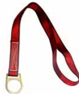
PUNTO DE ANCLAJE MOVIL LONGITUD FIJA 1.00 M DISEÑADO EN CINTA PLANA 28 MM. (POLIESTER), ARGOLLA GRANDE EN UN EXTREMO Y LAZO EN CINTA, PROCESADO SOBRE UN PAD DE APOYO EN CINTA PLANA BICOLOR 45 MM (POLIESTER), PARA FUNCION DE PROTECCION ANTE SUPERFICIES ABRASIVAS, BORDES AFILADOS, PREVENCION DE DESGARROS
